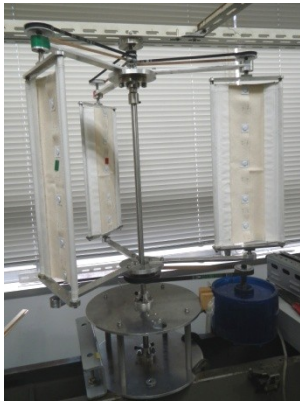
図1 可変ピッチ式帆布羽根垂直軸風車
